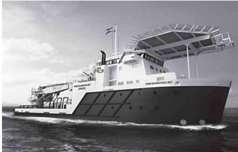
Artist's impression van het nieuwe diving offshore construction vessel dat wordt uitgerust met een saturatieduikstelsel (afbeelding: Noordhoek Offshore).
